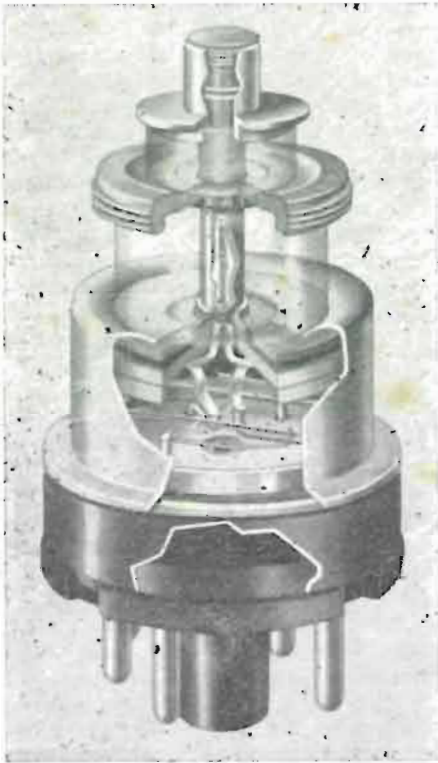
Fig. 2 - Spaccato di un tubo amplificatore ad elettrodi piani (lighthouse) per UHF. Si tratta del triodo EC56 Philips.
